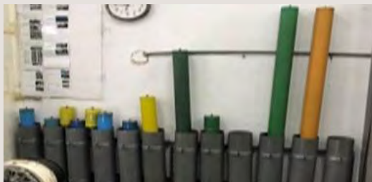
壓輪區存放處未標示規格及名稱 人員取用不易，有誤用風險
